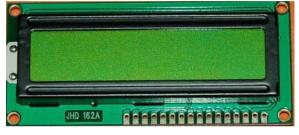
Fig. F. 16x2 LCD Display
