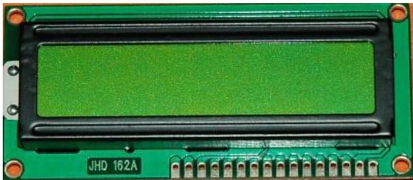
**Fig. F. 16x2 LCD Display**
