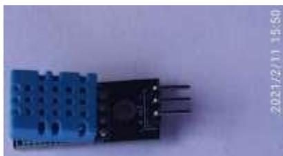
Fig -5: DHT11 Sensor
