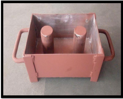
Actual Form Work for Brick
